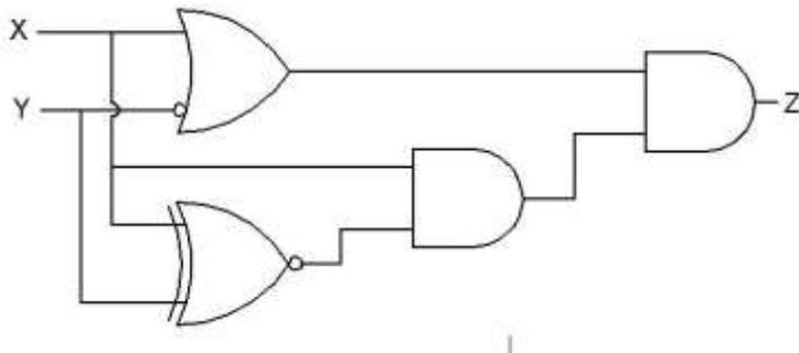
Prestar atención a los elementos negados. En el segmento 1, la negación afecta solo al valor de Y, por lo tanto el círculo que simboliza la negación en el circuito se coloca en la entrada de Y a la operación correspondiente.
