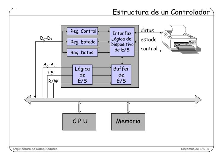
Los controladores de dispositivos varían mucho en la complejidad y en el número de dispositivos que controlan, aunque suelen estar formados, básicamente, por uno o varios procesadores de propósito específico para el tipo de dispositivo al que está dedicado, de un buffer o memoria local, y de unos registros o puertos para comunicarse con la CPU y con el dispositivo.
