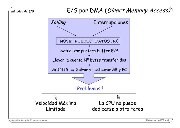
En los apartados anteriores hemos visto dos sistemas para realizar la E/S: por *polling* y por interrupciones, y en ambos casos la transferencia del dato se acababa realizando mediante una instrucción del tipo MOVE PUERTO\_DATOS, RO
