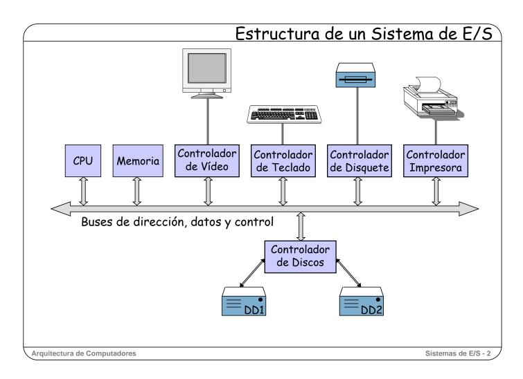
Un sistema de entrada/salida requiere tanto los componentes hardware necesarios, como una estructura de programas que manejen adecuada y eficientemente los dispositivos. Veamos entonces la estructura tanto del hardware como de los programas implicados en las operaciones de entrada/salida.
