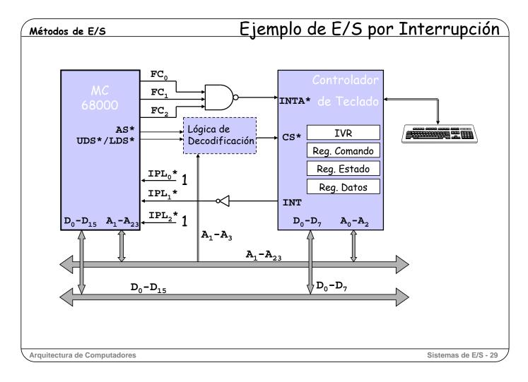
Aquí tenemos el esquema simplificado de un sistema de lectura de teclado desde un procesador Motorola 68000 que utiliza la técnica de las interrupciones.
