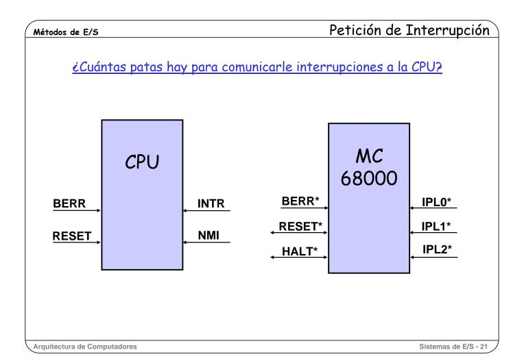
Ya sabemos que en un sistema hay múltiples tipos de interrupciones externas, las cuales se le comunican a la CPU mediante una señal hardware, o sea, una pata del procesador. Esto sugiere varias preguntas:
