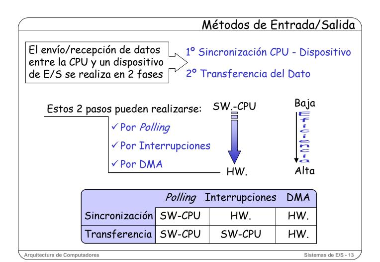
Una vez desarrollado el hardware que conecta los dispositivos de E/S con la CPU, se debe implementar el software que lo controla. El envío o recepción de un dato a/desde un dispositivo de E/S se debe realizar en dos pasos:
