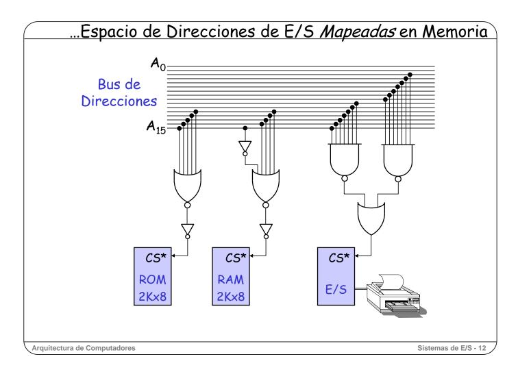
En esta figura podemos ver cómo se conecta el controlador de un dispositivo de entrada al bus de direcciones para compartir el espacio de direccionamiento de la CPU con otros "dispositivos", como la memoria.
