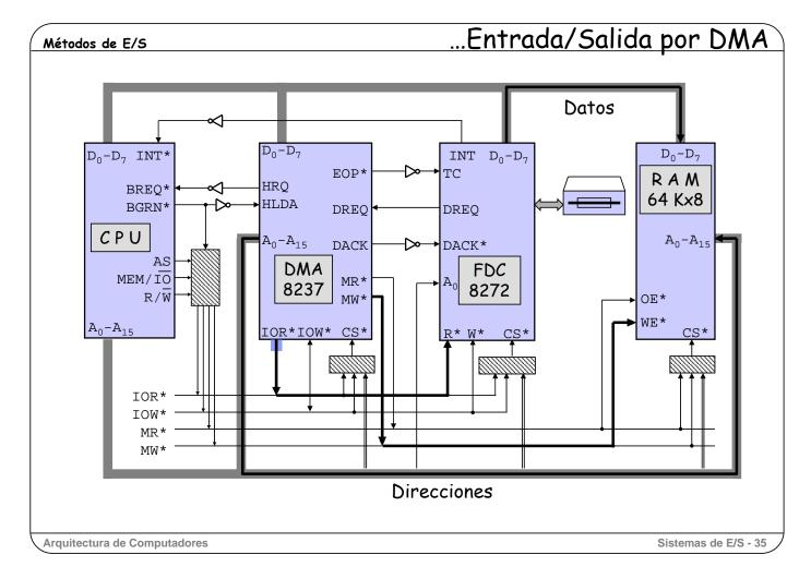
Aunque el controlador de DMA (o simplemente DMA) puede transmitir datos sin intervención de la CPU, previamente debe ser programado por ésta. Para arrancar la transferencia de un bloque de datos, la CPU le debe suministrar, al menos, la siguiente información básica:
